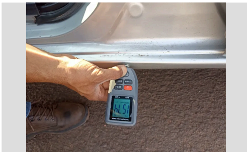
CAIXA DE AREIA ESQ REPARADO E AMASSADO
