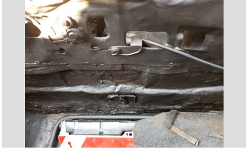
CAIXA DE STEP REPARADO
