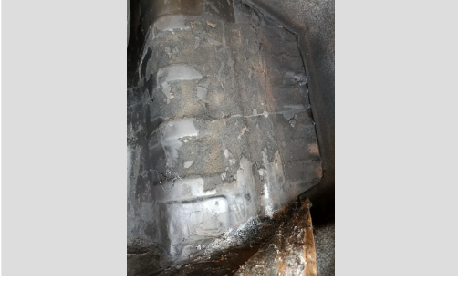
ASSOALHO PORTA MALAS REPARADO
